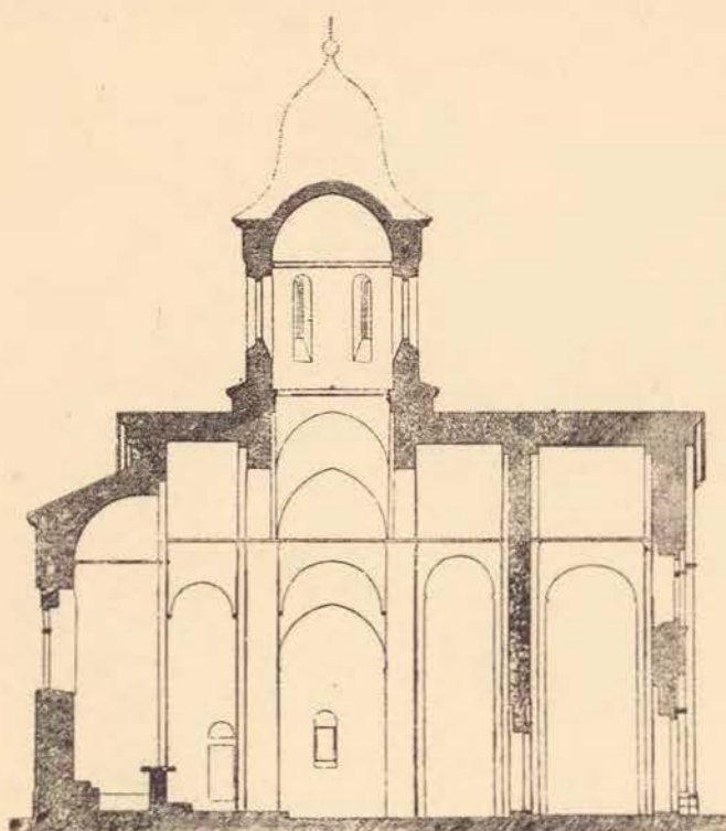
58. Cathédrale d'Arilje. Coupe longitudinale. (D'après Pokryškin).
